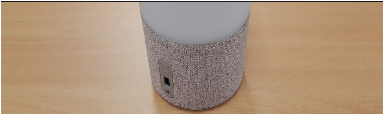
그림 4. USB 포트가 외부에 노출된 예시
