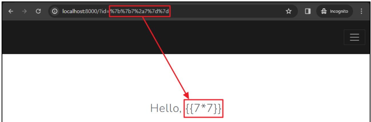
그림 8. Jinja2 Template Engine 에서 Sanitization 이후 {{7*7}} 구문 입력 시
